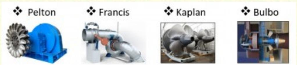
**Pelton:** As turbinas Pelton tem um rotor com características bem distintas dos demais tipos. Suas pás tem formato de concha. Este modelo opera em velocidades de rotação mais elevadas e é mais adequado para altas quedas, entre 350 e 1.100 metros.
